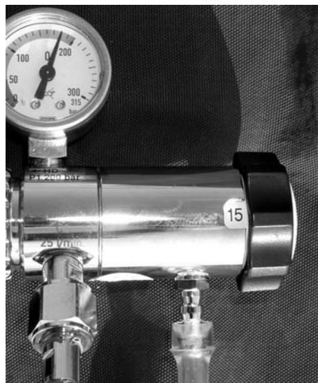
*Erogatore multifunzione con il flussimetro regolato a 15 lpm*
